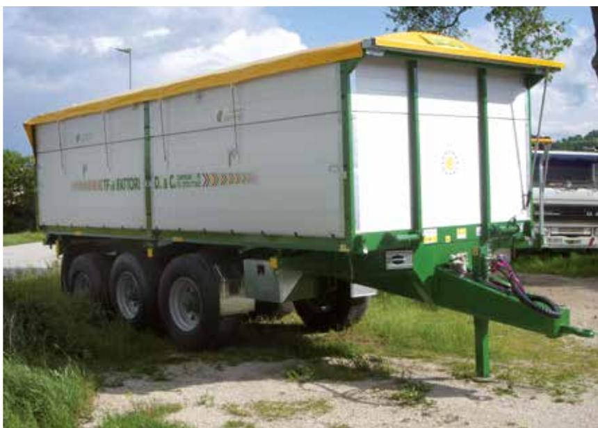
**Rimorchio agricolo DUMPER ribaltabile posteriore. BIASSE A BILANCIERE CON BALESTRE CANTILEVER O BIASSE A TANDEM. Assale posteriore autosterzante. TRIASSE A TRIDEM BALESTRATO. Assali autosterzanti, centrale fisso. Con ruote semplici nuove o usate. Frenatura pneumatica o idraulica misto-automatica. Omologato CEE**
