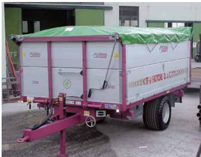
**Rimorchio agricolo trilaterale ribaltabile e inclinabile posteriormente. MONOASSE. Con ruote gemellate o semplici nuove o usate. Frenatura idraulica azionabile dal pedale del trattore. Omologato CEE**
