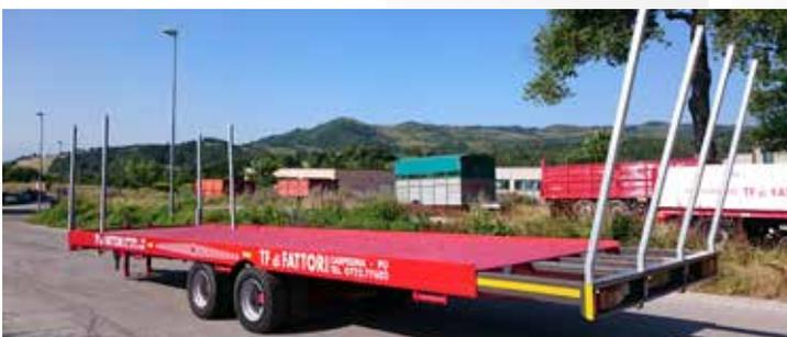
Ruote semplici o gemellate nuove o usate. Frenatura pneumatica o idraulica azionabile dal pedale del trattore. Prolunga posteriore del pianale ad azionamento meccanico o idraulico.
