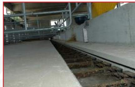
Impianti forniti con motoriduttori epicicloidale con motori trifase da 1,5 a 5,5 HP per impianti da 30 mt di catena lineare fino ad oltre 220 mt. oppure gruppi riduttori ad assi paralleli con trasmissione a cinghie per un tiraggio massimo di 120 mt di catena lineare.
